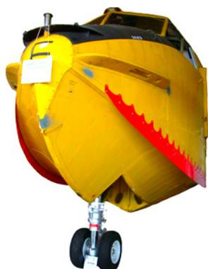
**Cockpit de Canadair CL-215, 1969** : Ce cockpit (poste de pilotage) est celui d'un Canadair CL-215, hydravion amphibie bombardier d'eau conçu par la société canadienne Canadair pour la lutte contre les feux de forêts. Capable de décoller avec 5 455 litres d'eau à son bord, il sera utilisé par la Sécurité Civile Française dès 1969. Le remplissage des réservoirs se fait en une dizaine de secondes en hydroplanant (effleurant) à la surface de l'eau.
